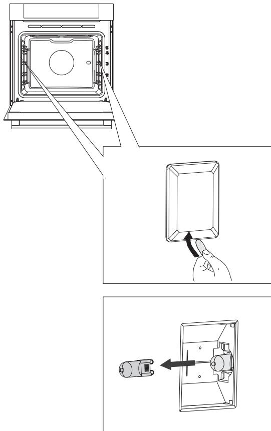
**1** С помощью отвертки снимите крышку.
