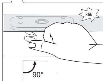
Пальцем отодвиньте замок вправо на  $90^\circ$  до щелчка. Замок дверцы заблокирован (в нерабочем состоянии).
