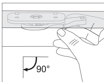
Чтобы разблокировать замок, откройте дверцу духовки и указательным пальцем потяните замок на себя. Замок дверцы разблокирован (в рабочем состоянии).
